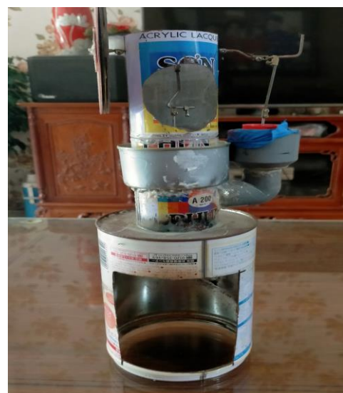
Hình 2. Mô hình sản phẩm động cơ Stirling do SV lớp TDH K13 chế tạo
